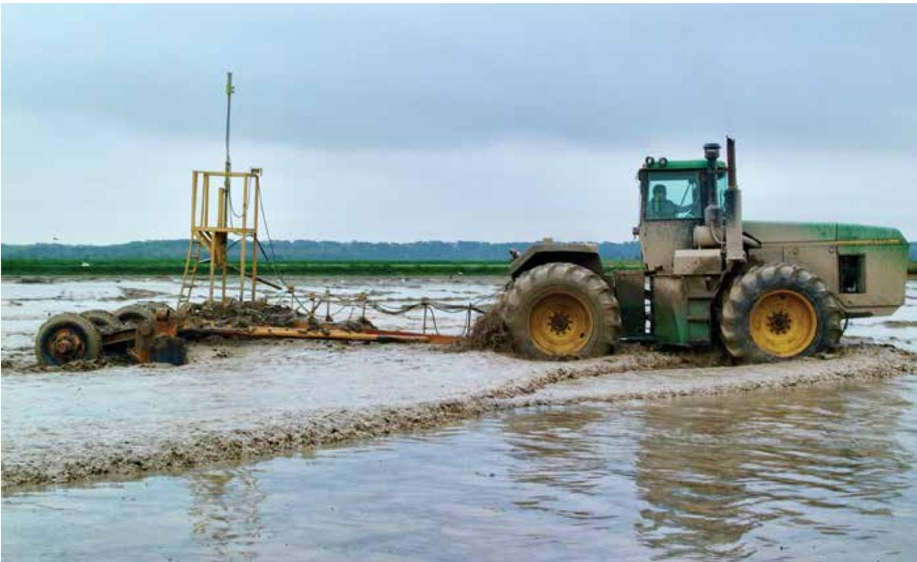
*Fig. 1-4. Water leveling.*
