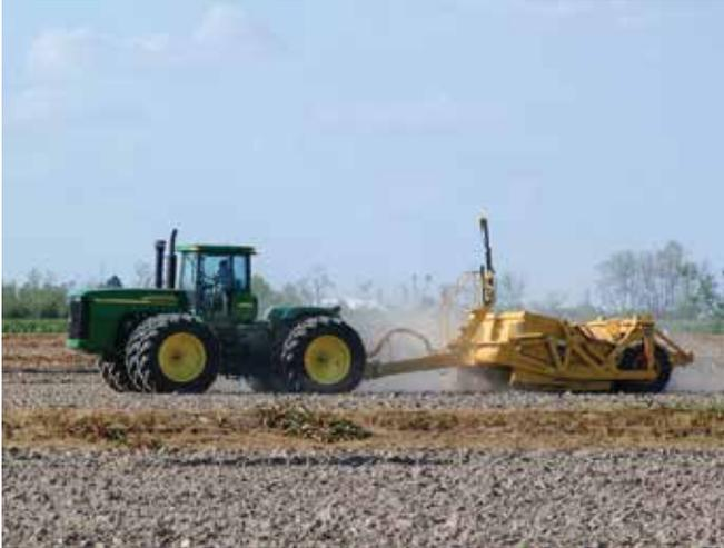
*Fig. 1-3. Laser leveling.*
